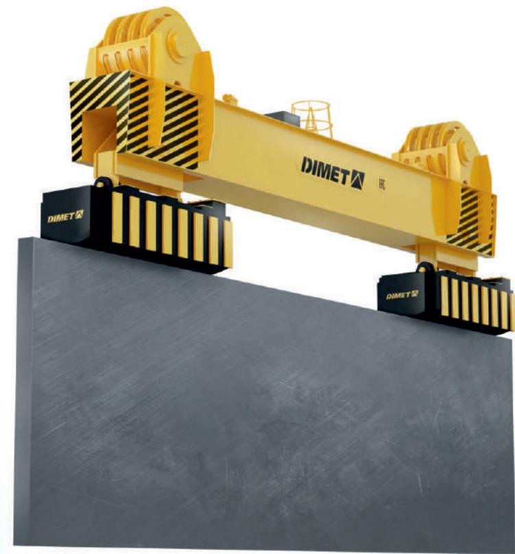
Магнитные траверсы DIMET для мягкого кантования слябов разработаны в комплексе с электромагнитами DIMET ЭМГМ с целью повышения эффективности и безопасности при работе со слябами на производственных линиях металлургических предприятий.
