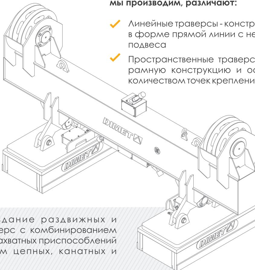
Возможно создание раздвижных и поворотных траверс с комбинированием различных грузозахватных приспособлений и применением цепных, канатных и ленточных строп
