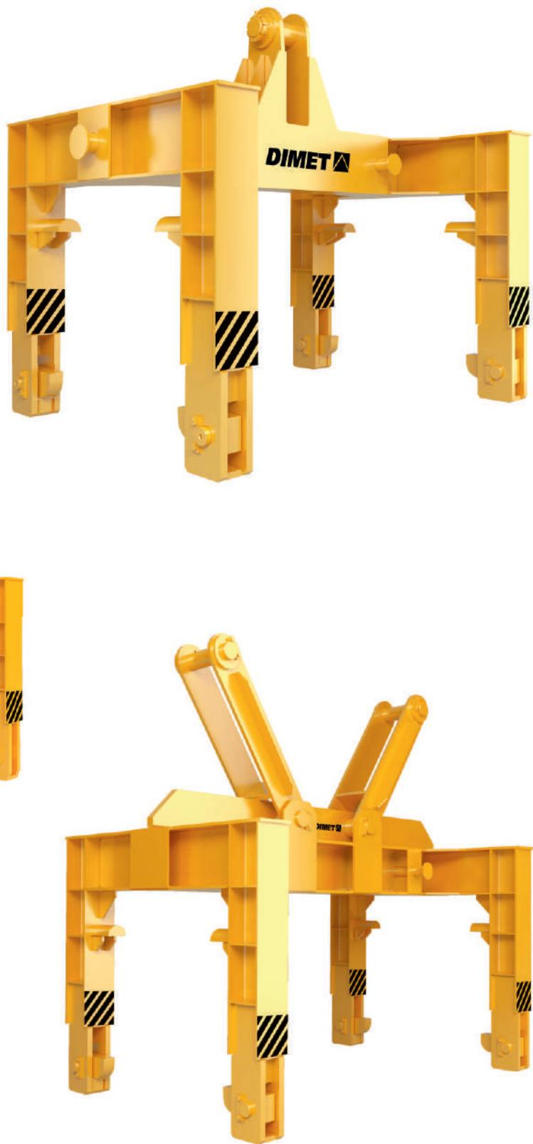
**Пространственная траверса DIMET** для транспортировки валков стана состоит из сварного корпуса с щеками для подвеса груза, которые врачаются на оси. В зависимости от грузоподъемного крана, траверсы может быть оснащена подвесом под однорогий, либо двуярогий крюк.
